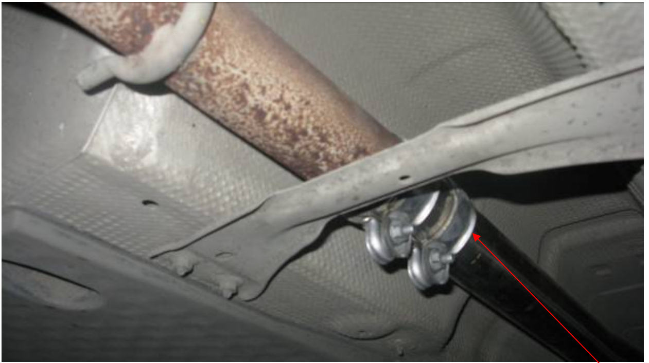
Фото 6. Место соединения приемной трубы глушителя и центрального глушителя.
