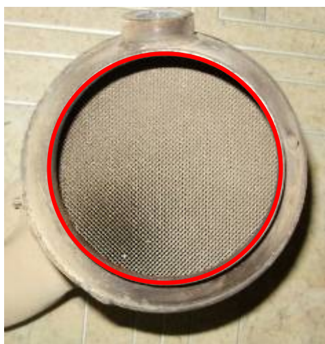
Фото 3. Каталитический нейтрализатор (вид с торца, красным цветом выделено место крепления фланца).
