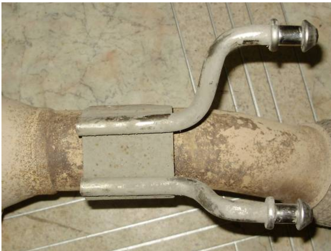
Фото 10. Общий вид переднего крепления приемной трубы глушителя, представленной на исследование (см. фото 4).
