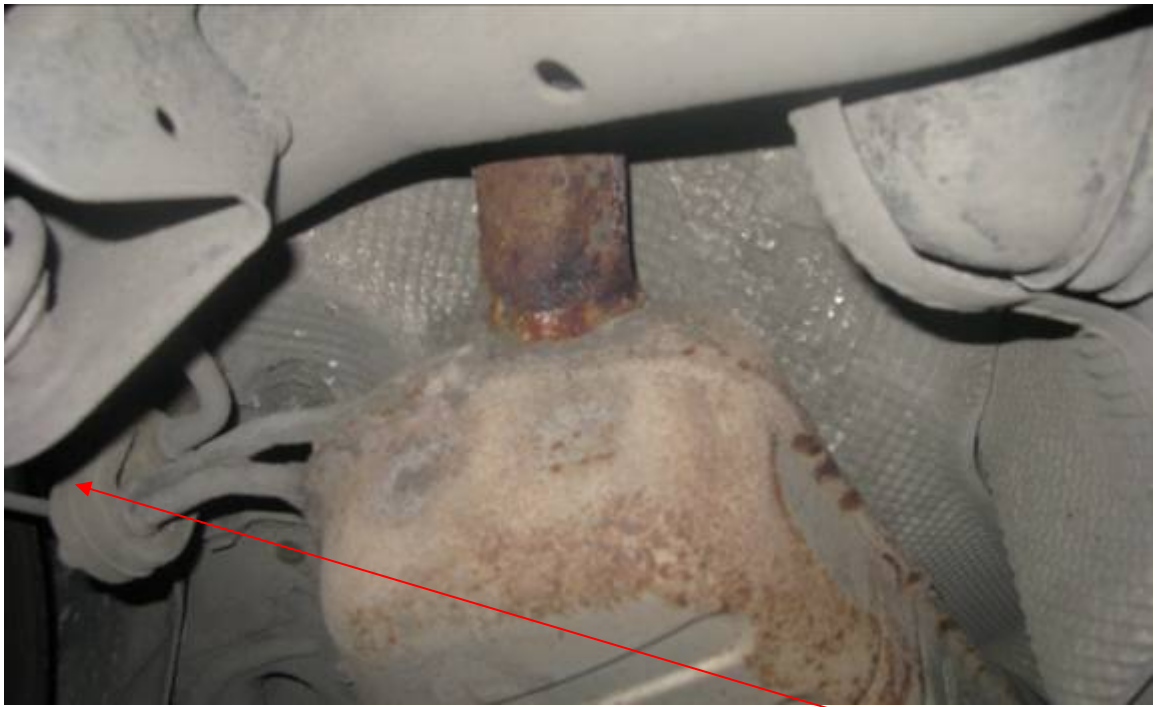
Фото 8. Заднее крепление центрального глушителя.
