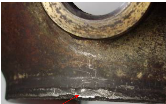
Фото 15. Металл, затекший в зазор свариваемых деталей.
