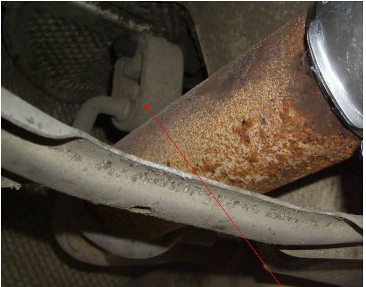
Фото 7. Переднее крепление центрального глушителя.
