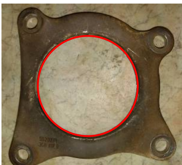
Фото 2. Общий вид фланца, представленного на исследование (красным цветом выделено место крепления к каталитическому нейтрализатору).
