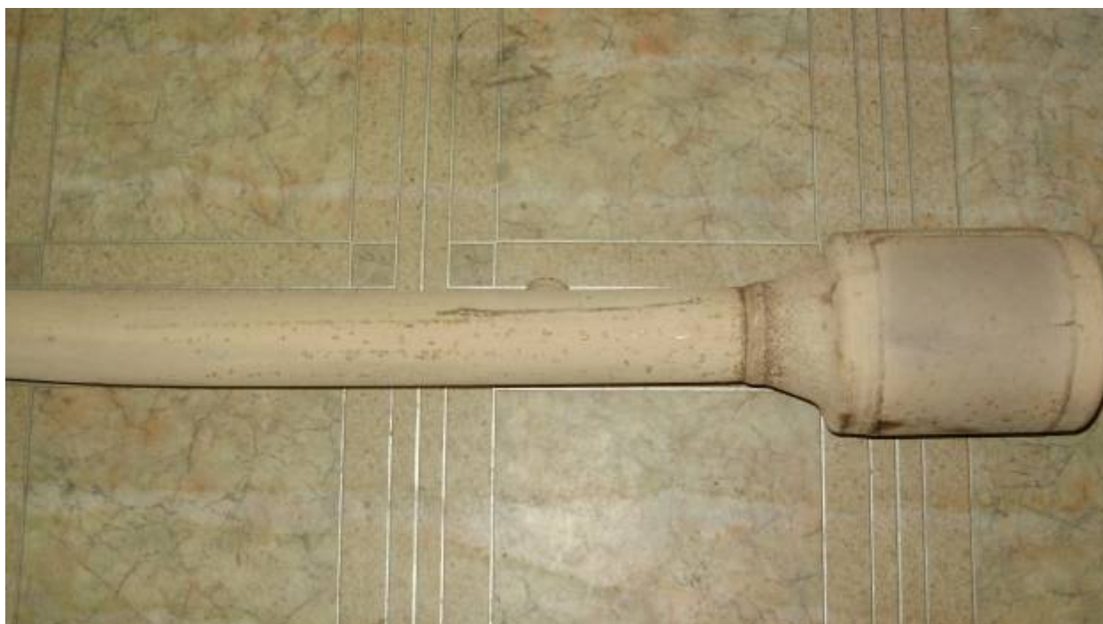
Фото 11. Общий вид средней части приемной трубы глушителя, представленной на исследование .
