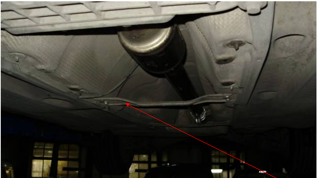
Фото 5. Поперечная планка в средней части приемной трубы глушителя.
