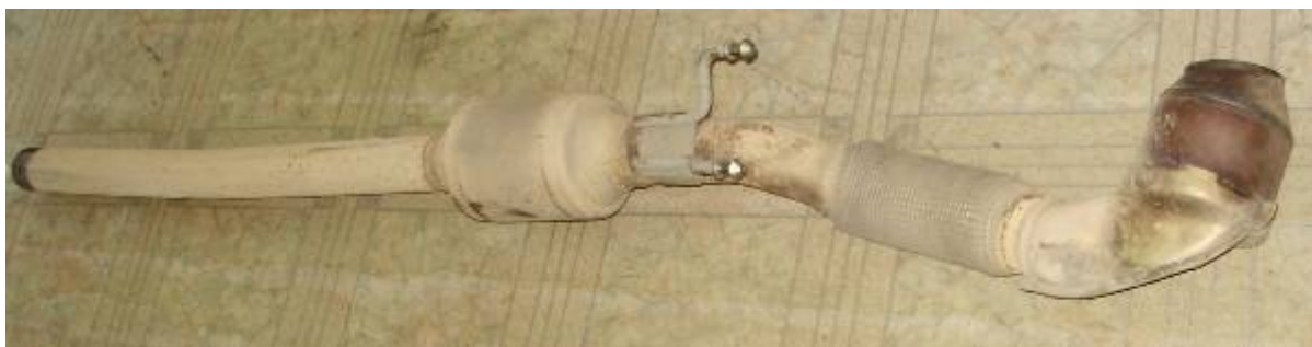
Фото 1.Общий вид приемной трубы глушителя с каталитическим нейтрализатором и гибкой секцией, представленной на исследование.
