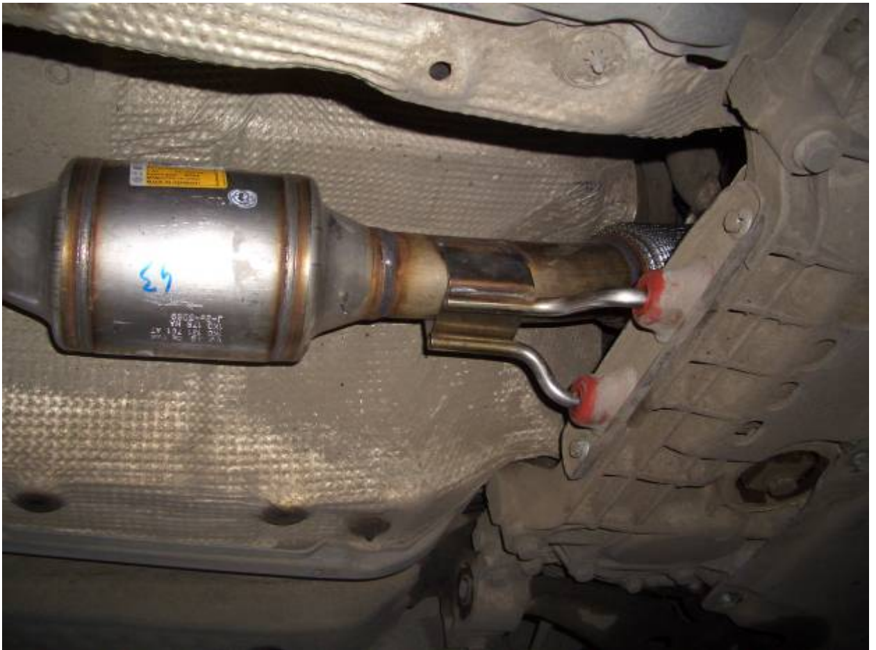
Фото 4. Опора каталитического нейтрализатора.
