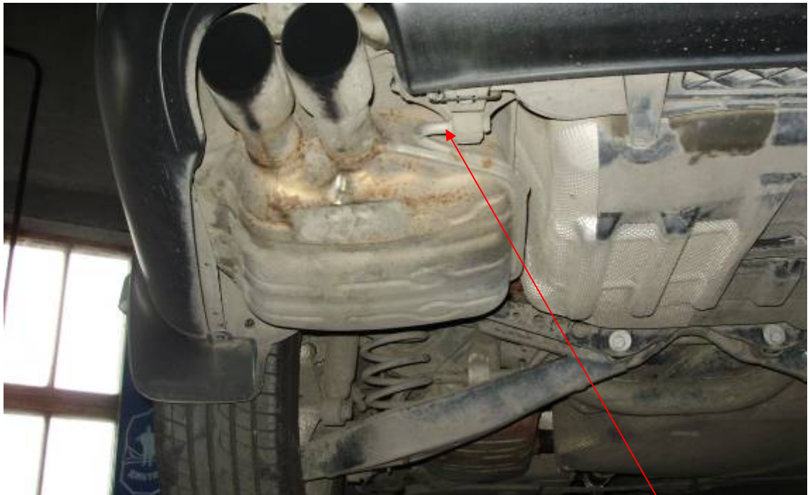
Фото 9. Заднее крепление дополнительного глушителя.
