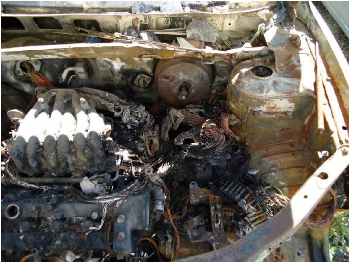
Фото 7. Зона максимальных термических повреждений.
