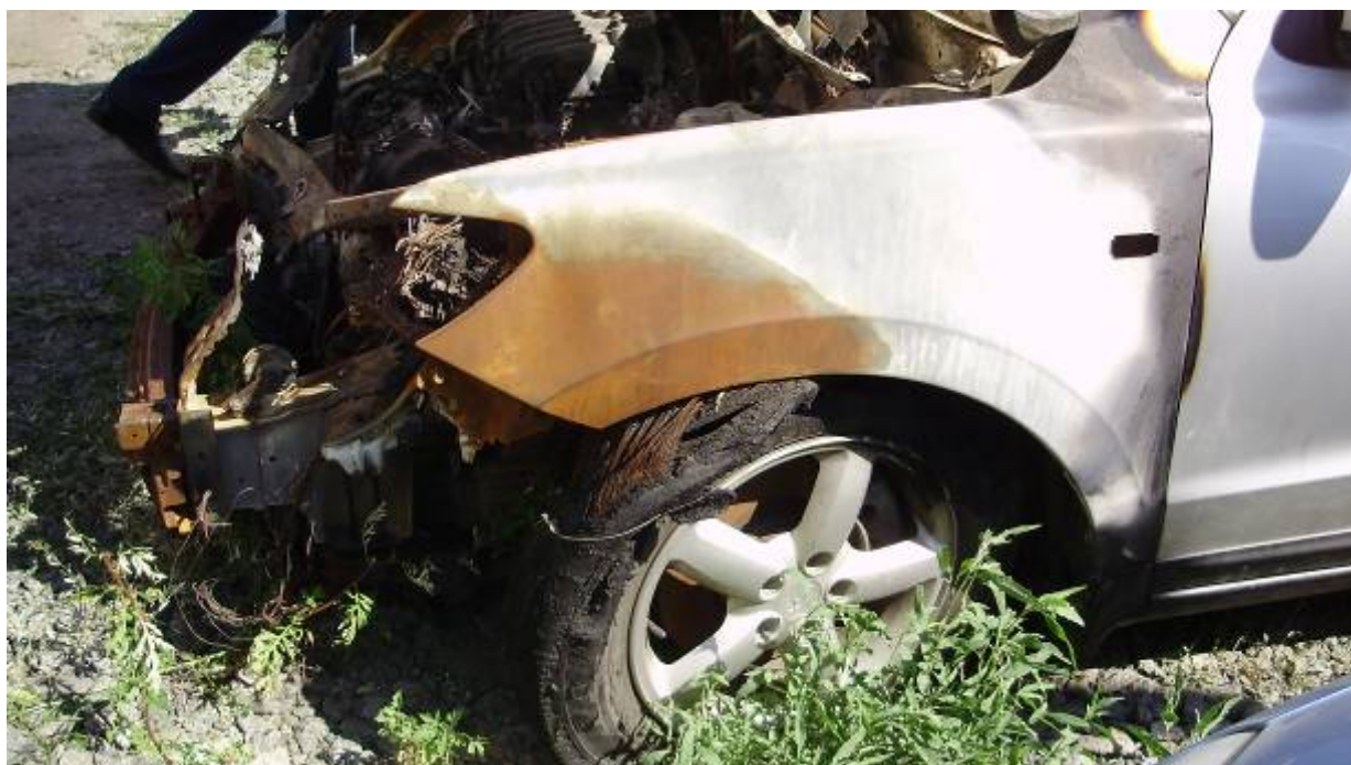
Фото 3. Термические повреждения со стороны левого переднего колеса.
