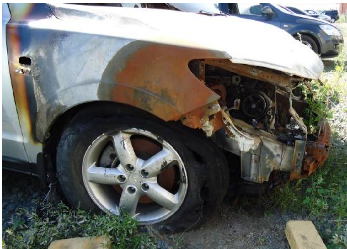
Фото 2. Термические повреждения со стороны правого переднего колеса.
