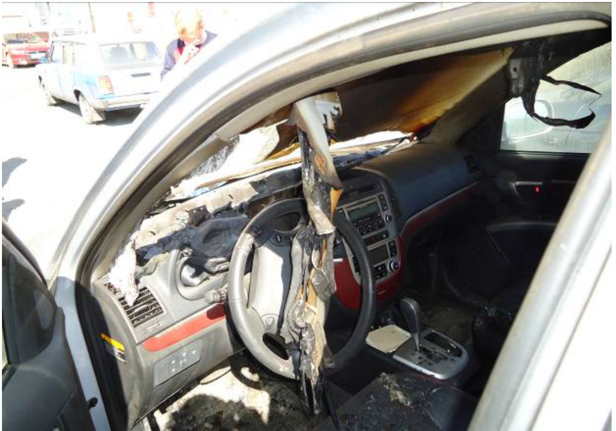
Фото 5. Термические повреждения в салоне автомобиля.
