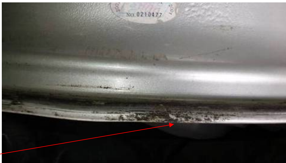
Фото 9. Замятие внутренней закраины и полки обода диска переднего правого колеса.
