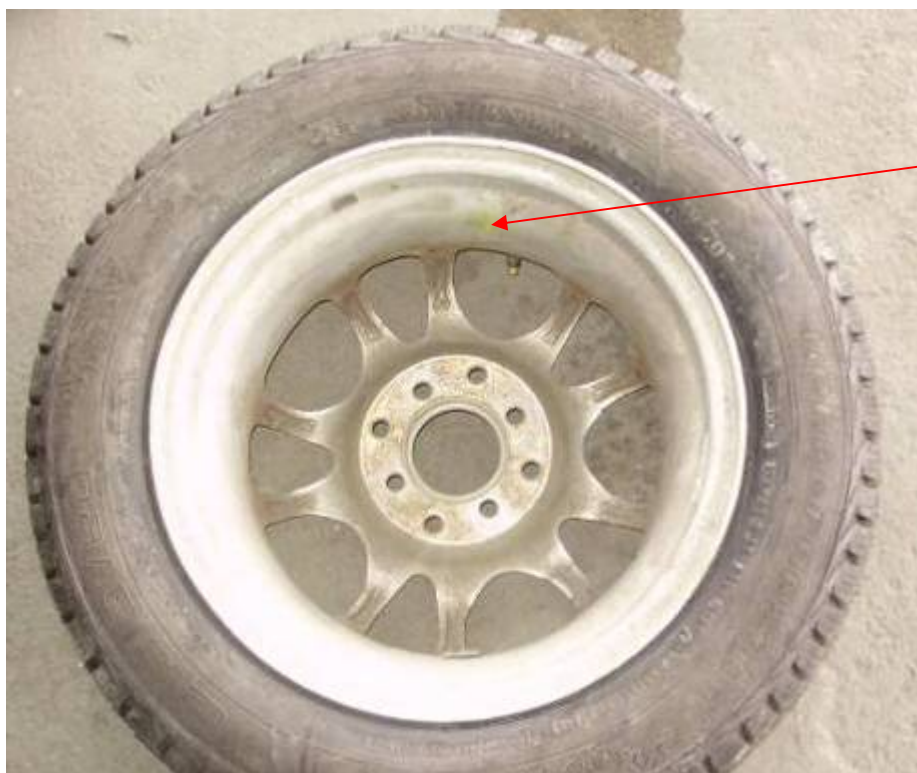
Фото 12. Переднее правое колесо в сборе (внутренняя сторона. Стрелкой указано место выхода воздуха).
