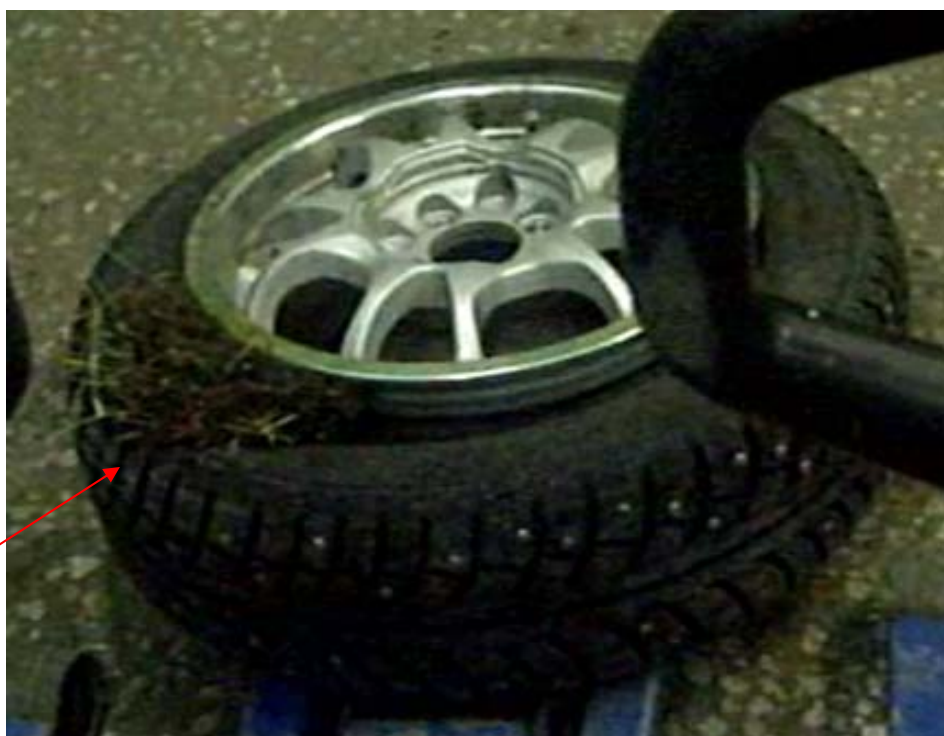
Фото 14. Грунт с травой между закраиной обода и бортом шины переднего правого колеса.
