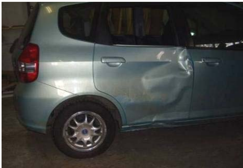
Фото 2. Повреждения задней правой двери и порога.
