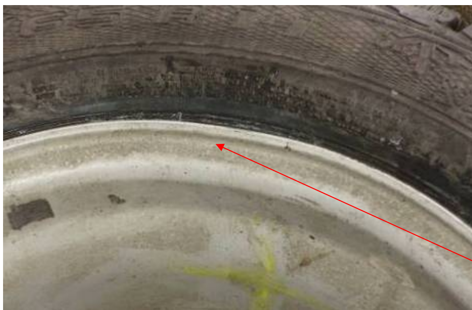
Фото 13. Замятая закраина переднего правого колеса ( желтая отметка - место выхода воздуха).
