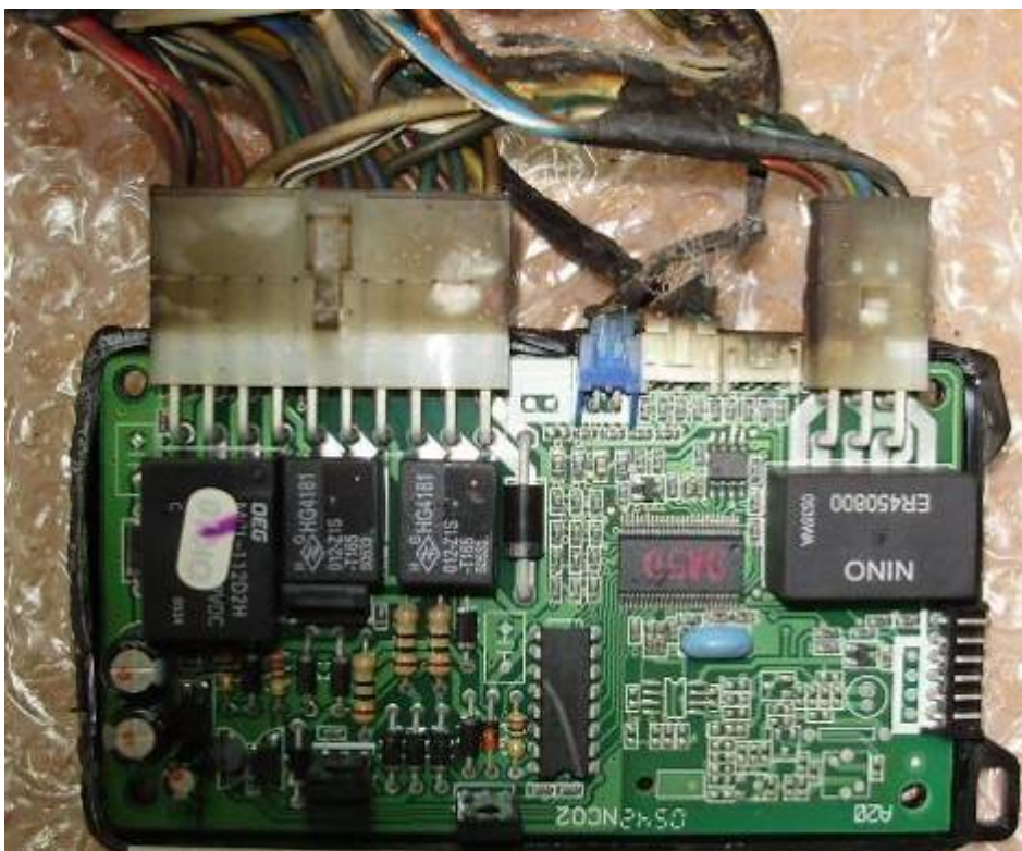
Фото 11. Блок сигнализации со снятой крышкой.
