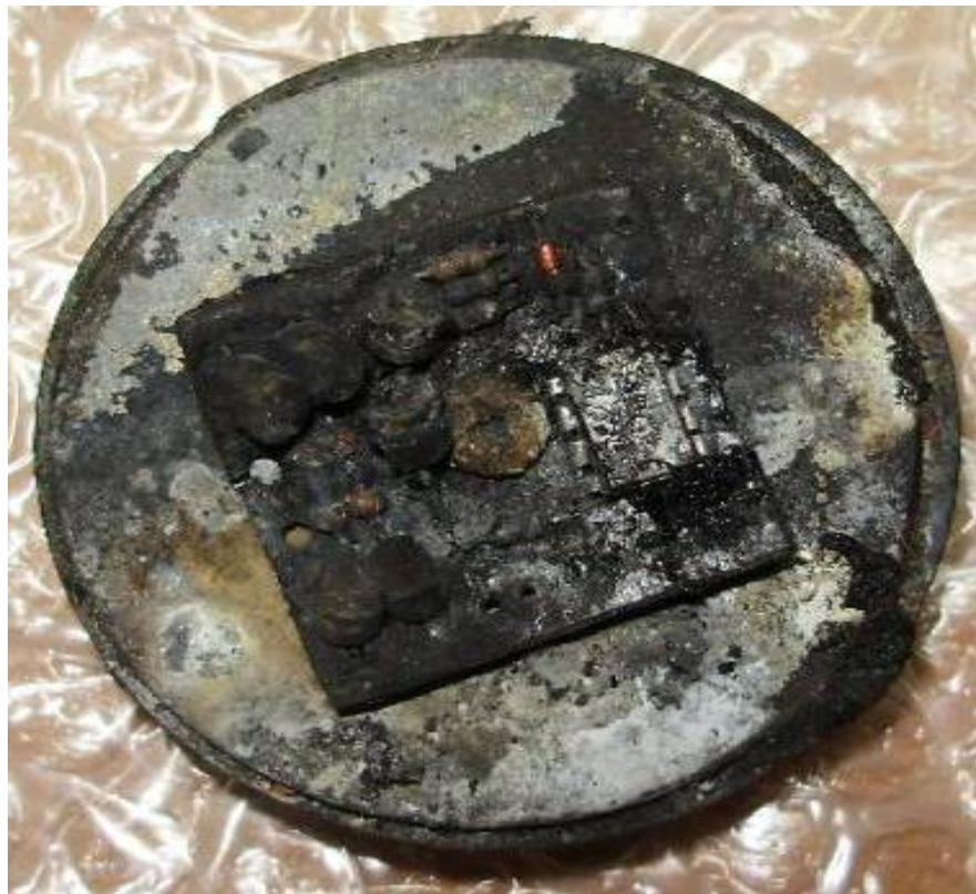
Фото 8. Внутренняя сторона задней стенки сирены сигнализации.
