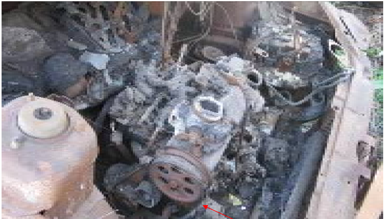
Фото 3. Общий вид моторного отсека автомобиля ВАЗ – 21101 г/н 000 на момент осмотра (стрелкой отмечено повреждение ремня ГРМ).
