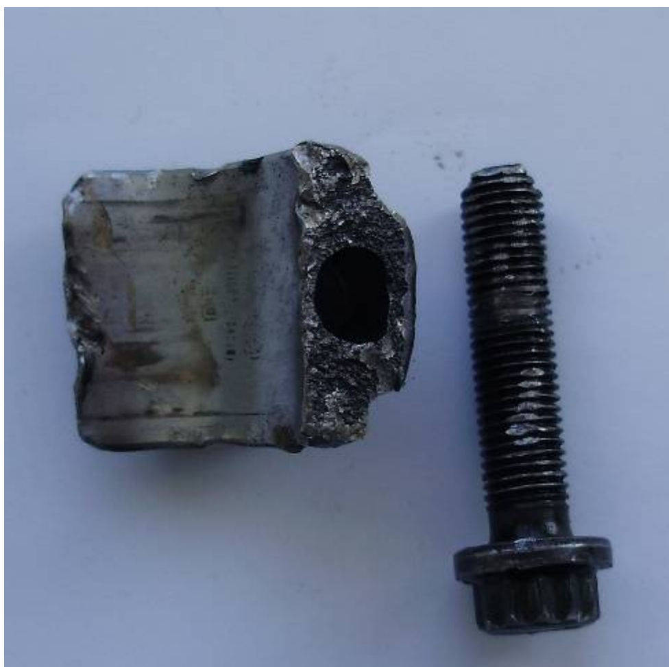
Фото 8. Общий вид части нижней крышки шатуна и соответствующего болта.
