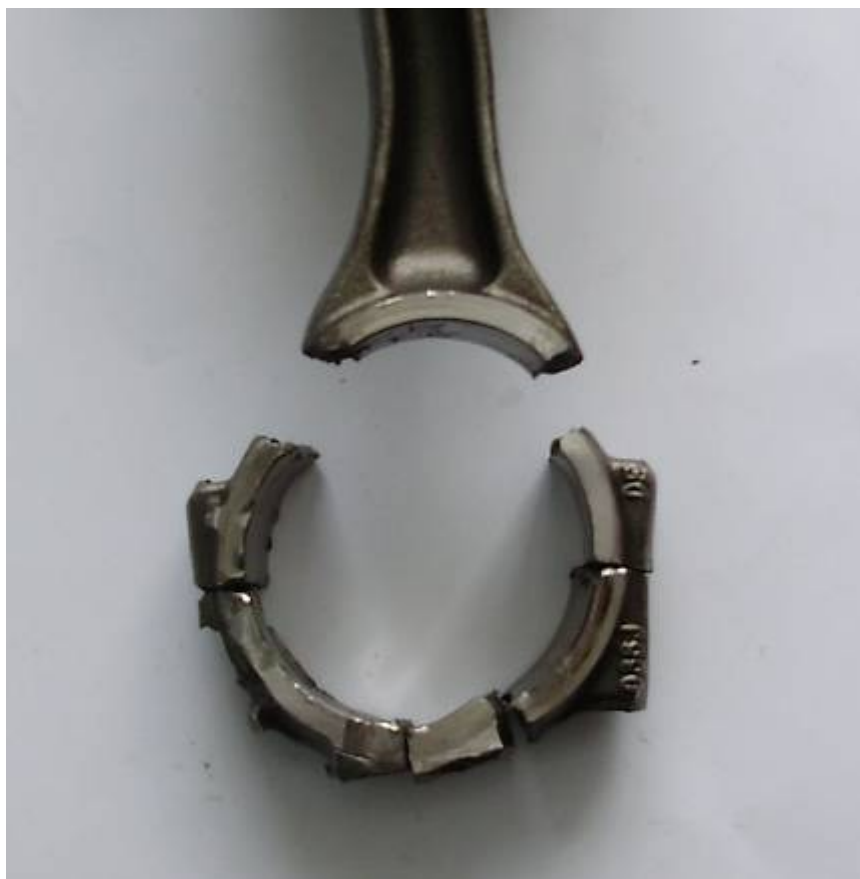
Фото 7. Разрушенные части нижней головки шатуна и крышки.
