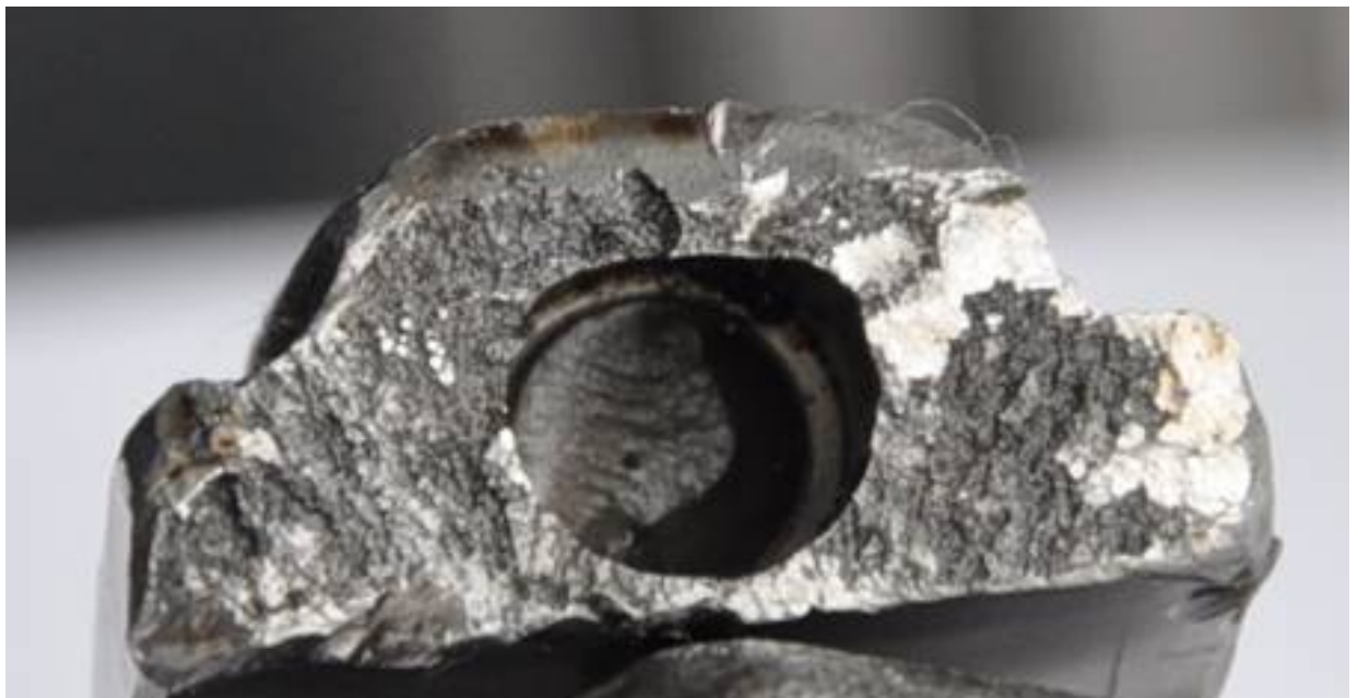
Фото 10. Часть крышки шатуна с оставшейся частью болта.
