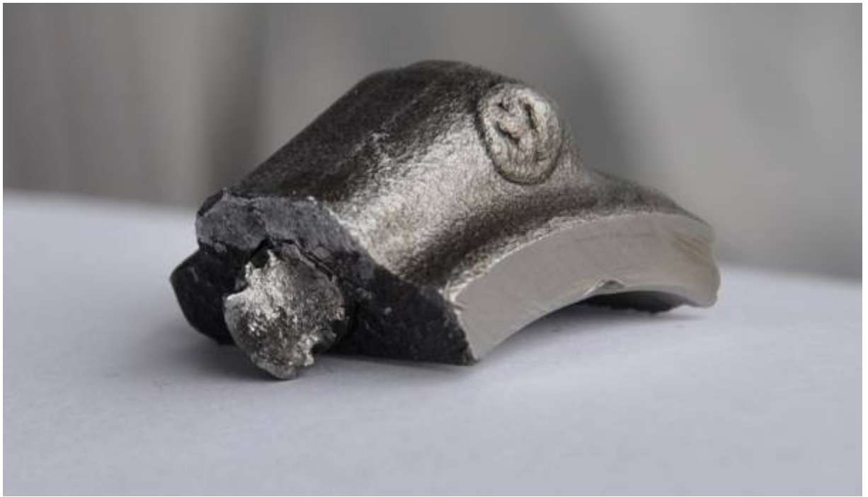
Фото 11. Вторая часть крышки шатуна первого цилиндра с оставшейся частью болта.
