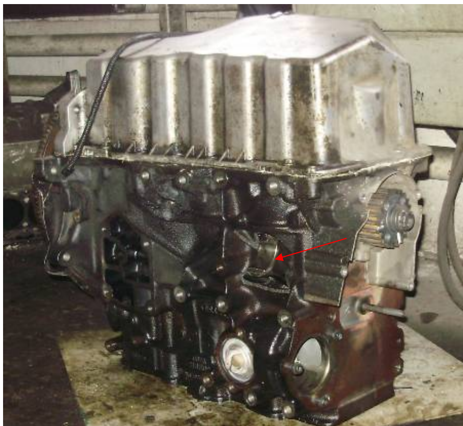
Фото 1. Общий вид двигателя (перевернут) слева спереди (стрелкой указано повреждение блока с нижней частью шатуна первого цилиндра).
