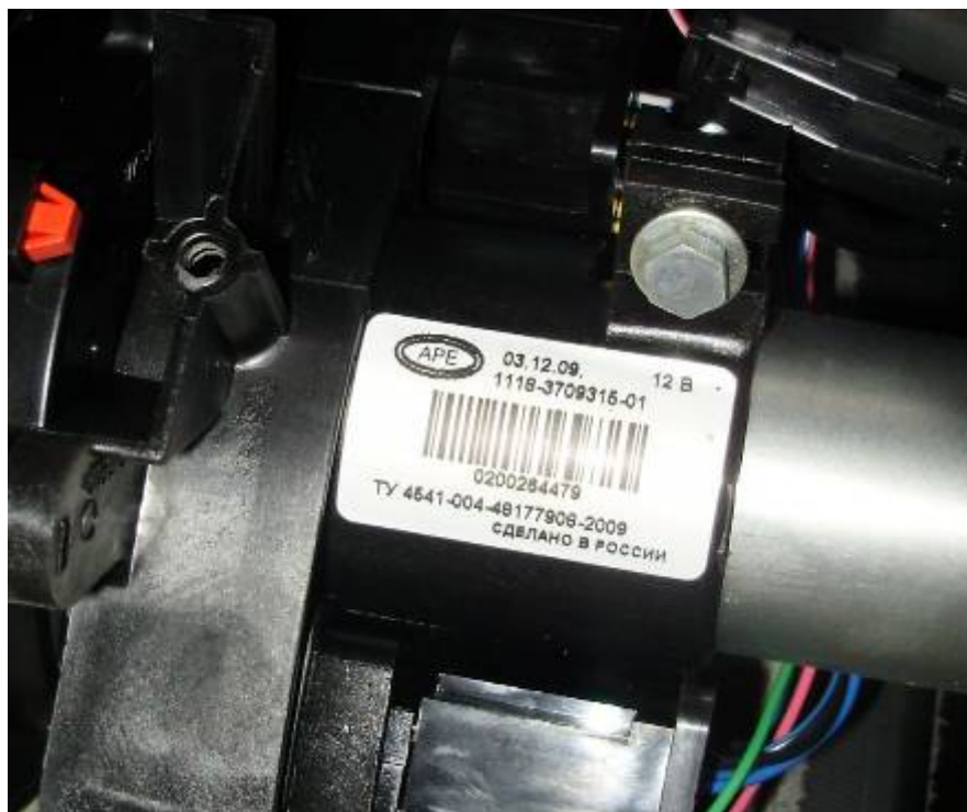
Фото 5. Заводская маркировка электромеханического усилителя рулевого управления автомобиля «ВАЗ - 217130».
